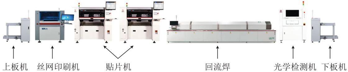
图 1-1 表面组装生产线的构成
