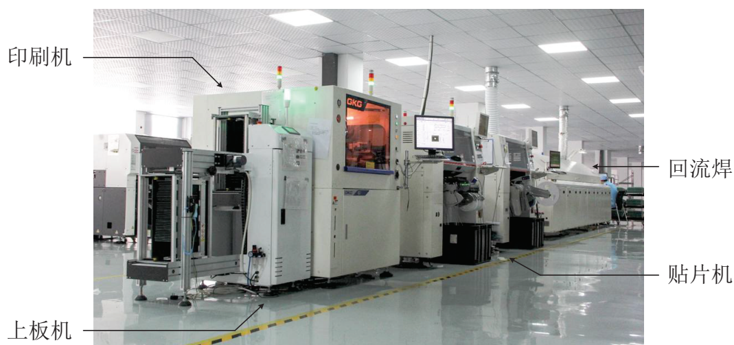
图 2-2 表面组装生产线的系统构成
